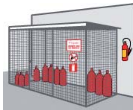
Rys. 10 Magazyn gazów technicznych na wolnym powietrzu
