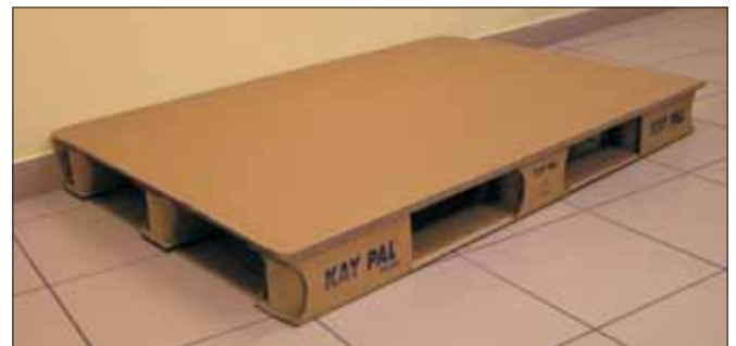
Fot. 1. Paleta ładunkowa płaska tekturowa jednopłytkowa czterowieściowa bez skrzydeł 800 mm x 1200 mm jednorazowego użytku (fot. A. Wojciechowski).
